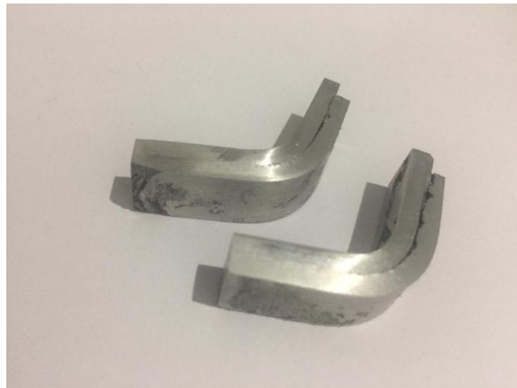
Spesimen Pengujian Bending ASTM E8/E8M-16a Setelah diuji Bending
