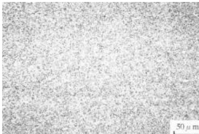
**Gambar 2.11** Gambar mikro dari lapisan pelapis baja tahan karat yang dihasilkan oleh *friction surfacing* (*Shinoda, 1998*).
