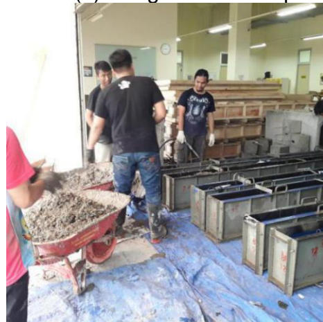
(c) Pemadatan beton
