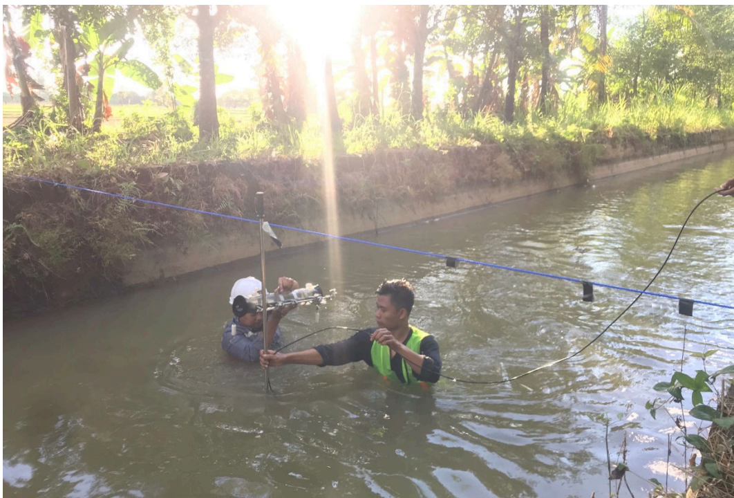
Lampiran 11. Pengambilan Data Kecepatan Menggunakan Current Meter
