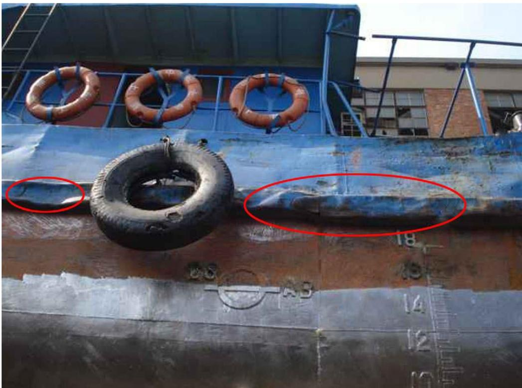
**Gambar 1.2** Fender baja kapal yang rusak
