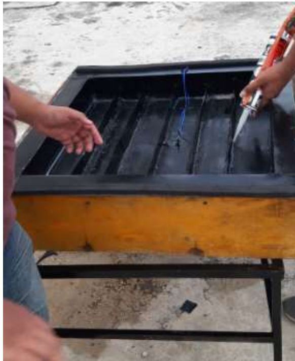
Gambar 2. Pengecetan dan Pengaplikasian Silikon pada Pelat Absorber fin
