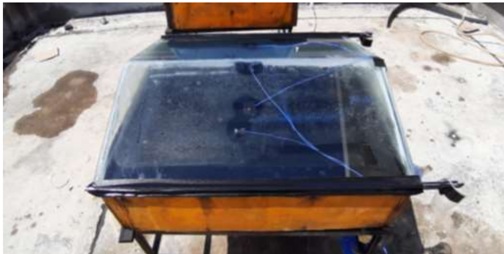
Gambar 8. Kaca Penutup Alat Distilasi yang telah dipasang termokopel
