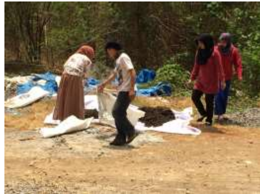
Proses pengeringan agregat
