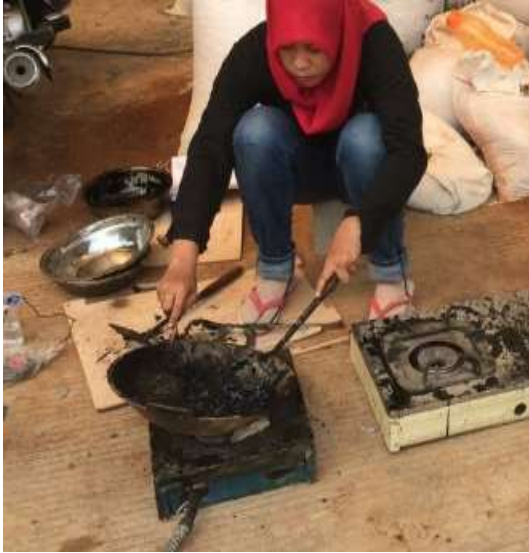
Proses Pemanasan Agregat dan Aspal Minyak
