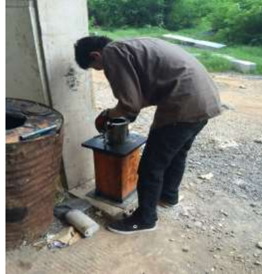
Proses Pemadatan Campuran Aspal
