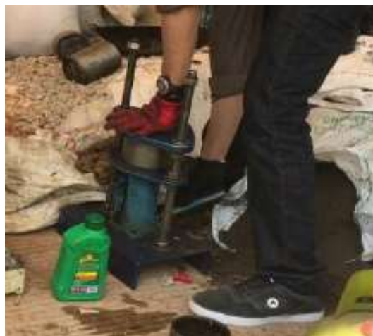
Proses pengeluaran benda uji dari mould dengan alat ejector
