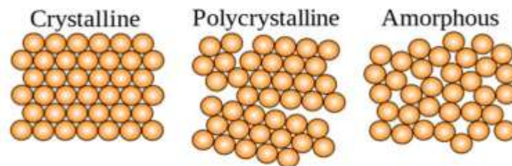
Gambar 12. Ilustrasi perbedaan keteraturan susunan atom untuk partikel padatan kristalin, polikristalin dan amorf (Zak et al. , 2013)
