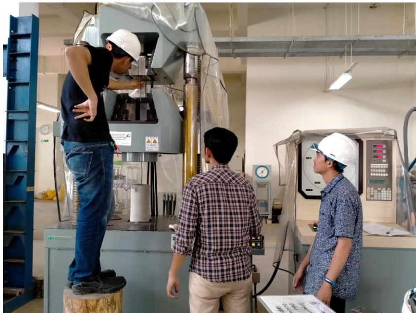
Dokumentasi pengujian kuat tarik baja
