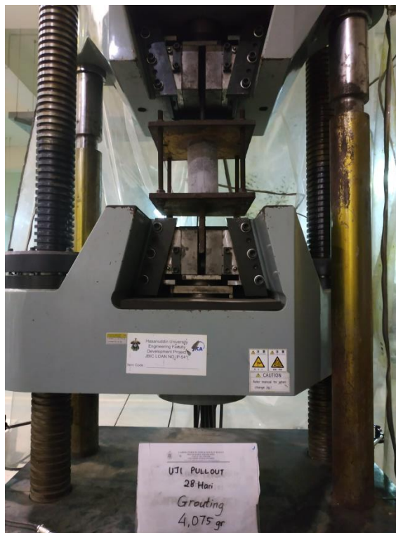
Dokumentasi pengujian pullout sampel grouting
