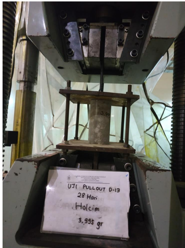
Dokumentasi pengujian pullout beton normal
