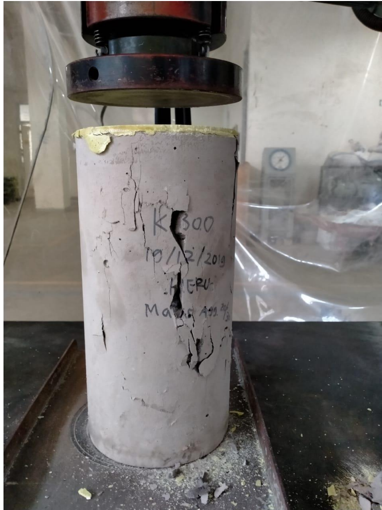
Dokumentasi pengujian kuat tekan beton normal
