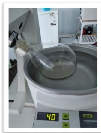
Gambar 5. Rotavapor ekstrak etanol timun laut untuk memisahkan pelarut dan ekstrak dengan suhu 40°C dan 1000rpm
