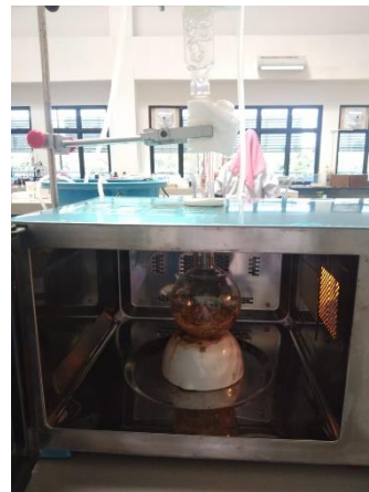
Gambar 17. Proses Ekstraksi dengan Microwave assisted extraction
