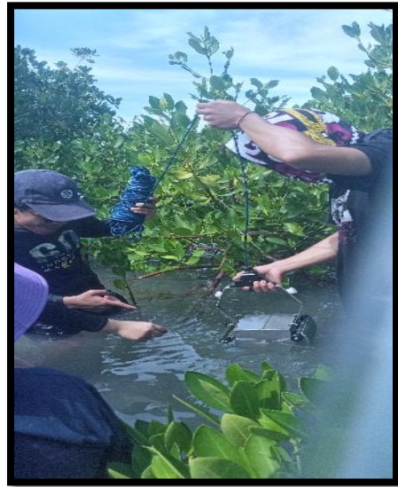
Pengambilan Sampel Sedimen Menggunakan Eijikman Grab
