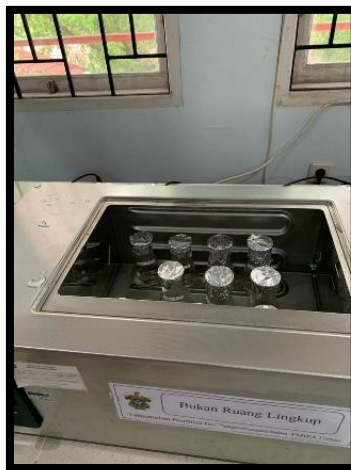
Gambar 13. Dipanaskan dengan suhu pemanasan 70 0 C selama 30 menit.
