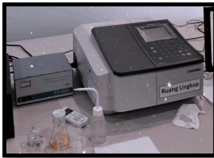
Gambar 14. Larutan diamati absorbansinya setiap 15 menit ( t_0;t_{15};t_{30} ) dengan spektrofotometer UV-Vis.
