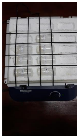
Pengocokan dengan alat shaker untuk pengaruh waktu dan konsentrasi terhadap adsorpsi DEHP
