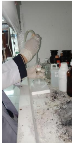
Pengaliran gas nitrogen untuk menghilangkan gas oksigen
