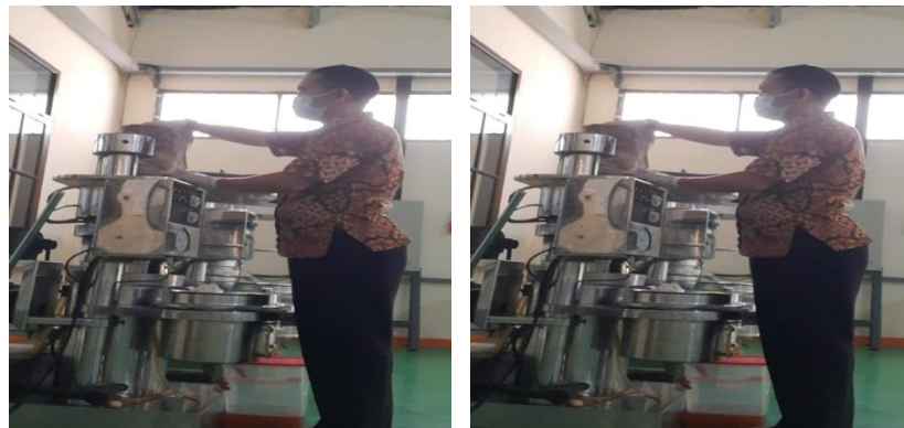
Gambar. 38. Proses press lemak kakao tanpa fermentasi dan fermentasi
