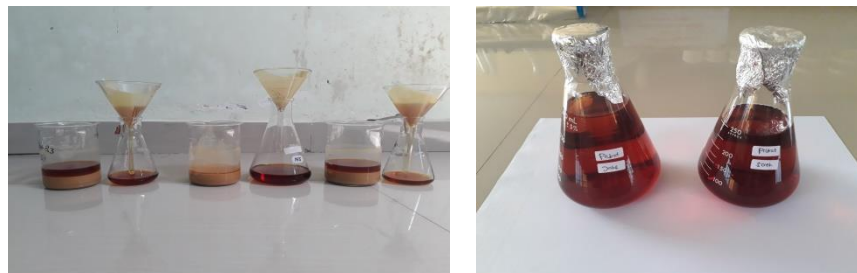
Gambar 51. Proses Penyaringan ekstrak jahe dan serai serta hasil filtrate jahe dan serai
