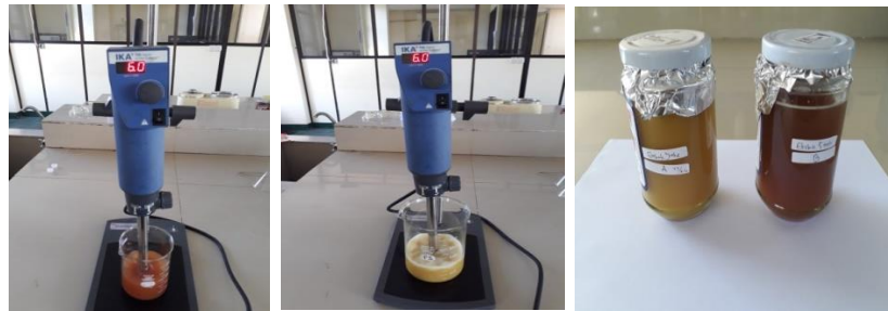
Gambar 12. Proses Homogenisasi dan pembentukan emulsi
