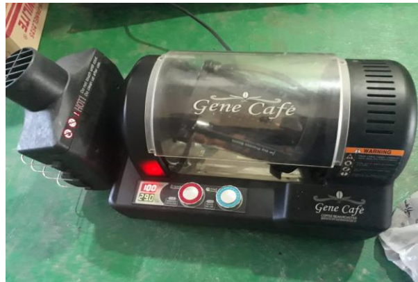
Gambar 30. Proses roasting biji kakao fermentasi
