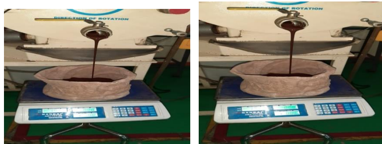
Gambar 37. Proses pengambilan pasta kakao kasar tanpa fermentasi dan fermentasi dan penimbangan pasta kasar
