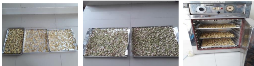
Gambar 3. Proses Pengeringan jahe dan serai di Oven
