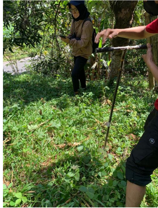
Pengukuran Kedalaman Tanah Menggunakan Bor tanah
