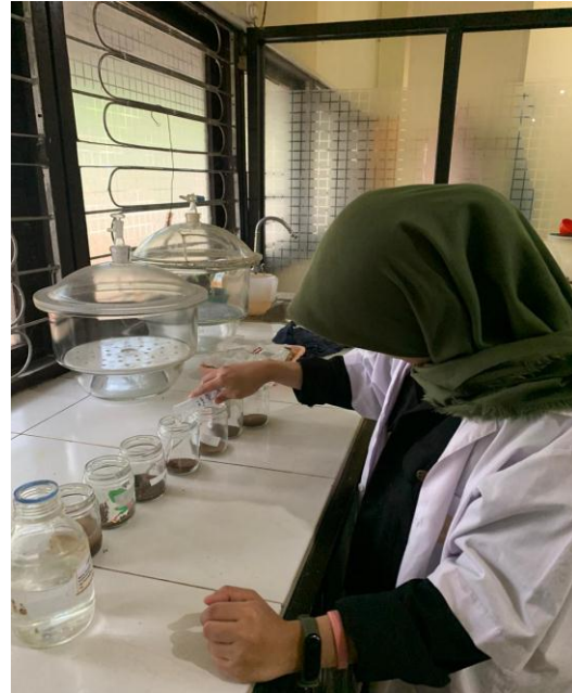
Penuangan Aquades untuk Pengujian Tekstur Tanah
