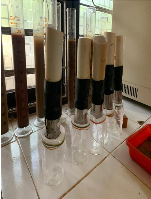
Pengujian Permeabilitas Tanah
