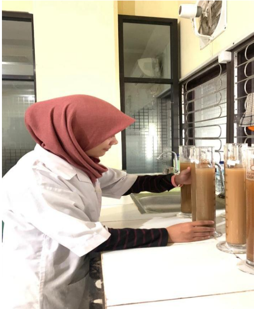
Pengamatan Suhu Sampel Tanah untuk Pengujian Tekstur Tanah
