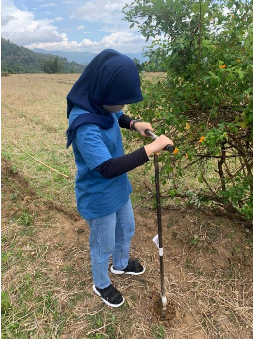
Pengukuran Kedalaman Tanah Menggunakan Bor Tanah
