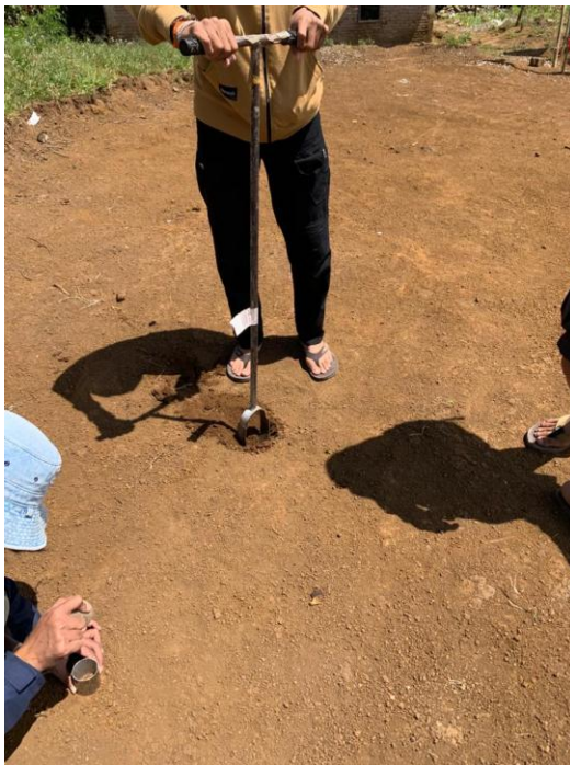
Pengukuran Kedalaman Tanah Menggunakan Bor Tanah
