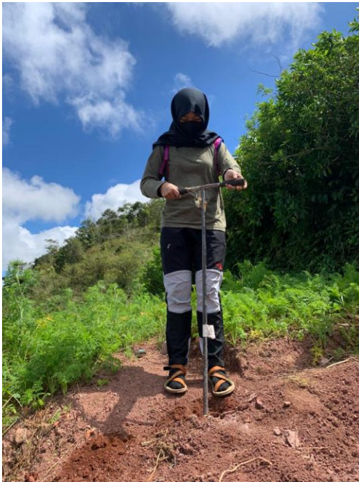
Pengukuran Kedalaman Tanah Menggunakan Bor Tanah
