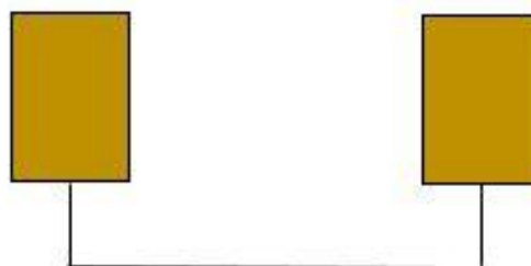
Gambar II. 17 Antena array Linear
