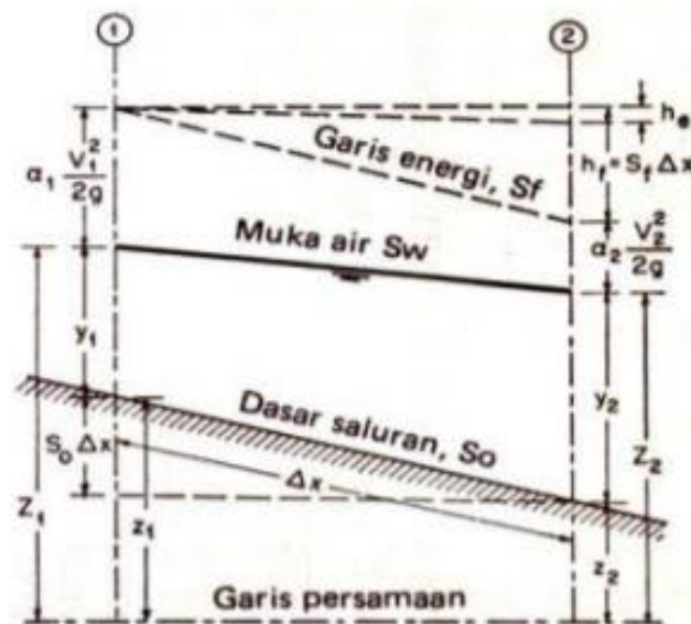
Gambar 2. Skema Bagian Saluran Peluncur
