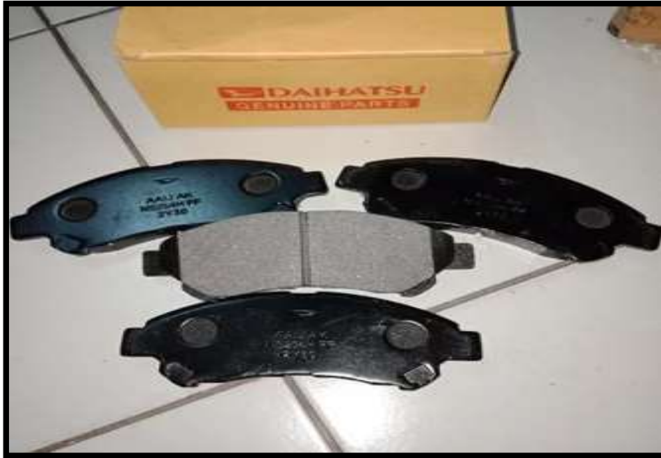
Gambar B 1. Kondisi Kampas Rem Depan Dan Belakang Mobil Pick Up Daihatsu Gran Max 1.5 3W FH
