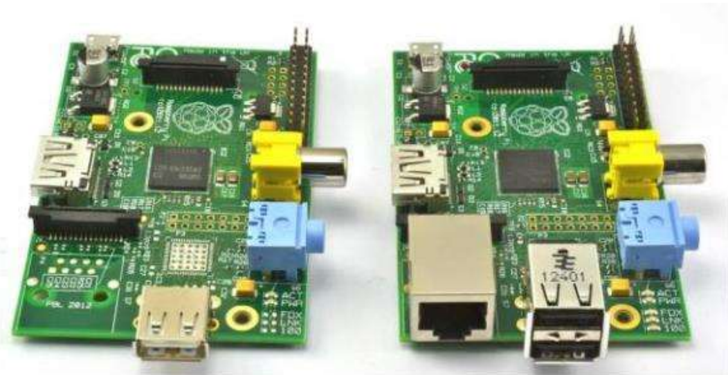
Gambar 2.1 Papan Raspberry Pi Model A (kiri) dan Model B (kanan)
