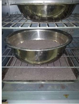
Pengeringan Pasir dalam Oven
