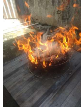
Pembakaran cangkang kemiri untuk mendapatkan abu cangkang kemiri
