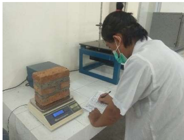
Penimbangan Benda Uji
