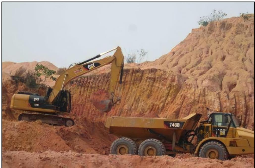
Gambar 2.1 Pola pemuatan material menggunakan *top loading* (Fatimah dkk, 2016)
