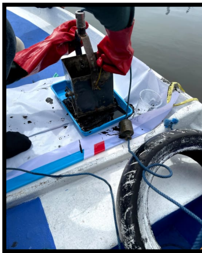
Gambar 9. Pengambilan Sampel Sedimen dengan Eijkman Grab
