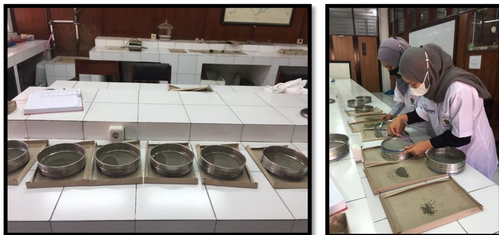
Gambar 12. Proses Analisis Ukuran Butir Sedimen
