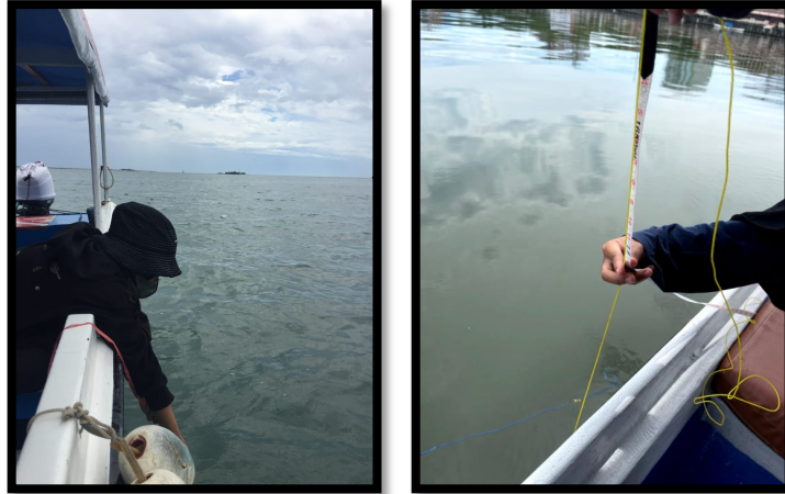
Gambar 8. Pengambilan Data Kedalaman Menggunakan Tali Ukur
