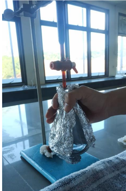
Gambar 13. Penetapan kadar asam oksalat ekstrak Daun Kelor ( Moringa oleifera Lamk)
