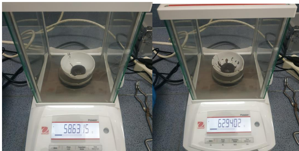
Gambar 7. Penetapan kadar air ekstrak Daun Kelor ( Moringa oleifera Lamk)
