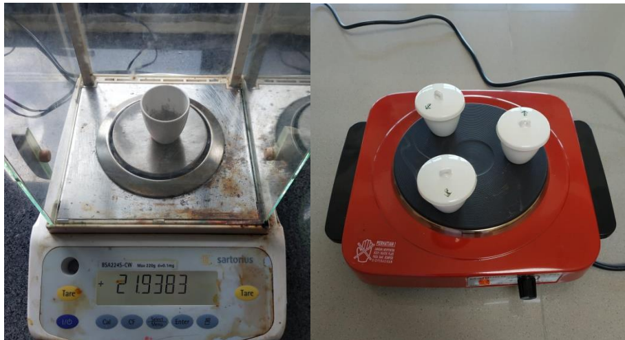
Gambar 8. Penetapan kadar abu ekstrak Daun Kelor ( Moringa oleifera Lamk)
