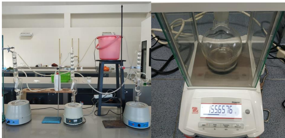
Gambar 12. Penetapan kadar lemak ekstrak Daun Kelor ( Moringa oleifera Lamk) dengan metode sokhletasi
