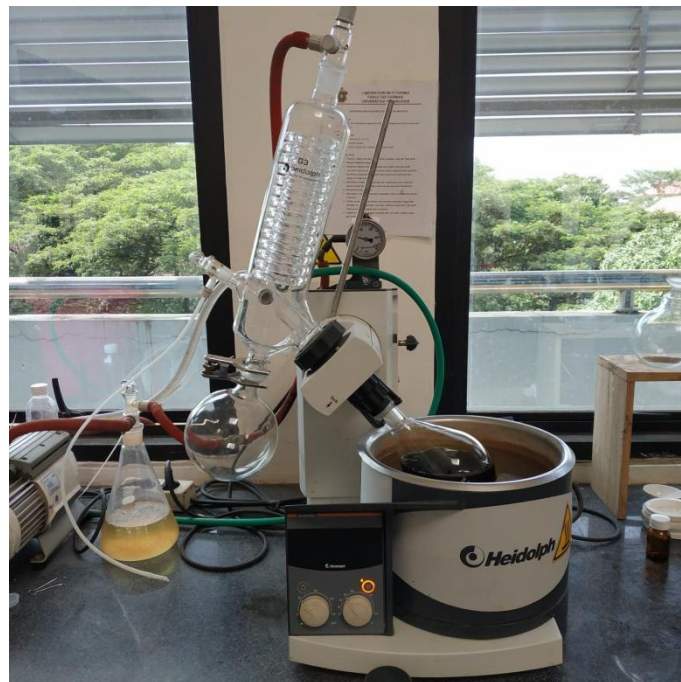
Gambar 5. Penguapan pelarut ekstrak Daun Kelor ( Moringa oleifera Lamk) dengan rotary evaporator
