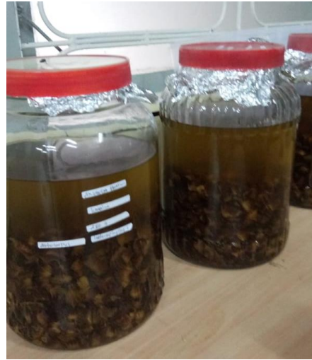
Gambar 13. Proses ekstraksi menggunakan metode maserasi
