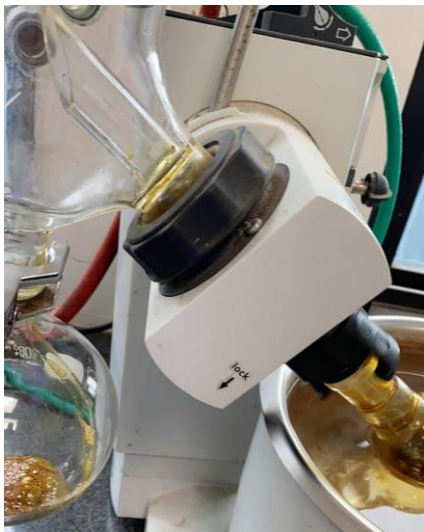
Gambar 14. Proses evaporasi menggunakan Rotary evaporator
