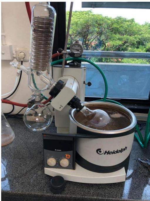
Filtrat diuapkan menggunakan *rotary evaporator*
