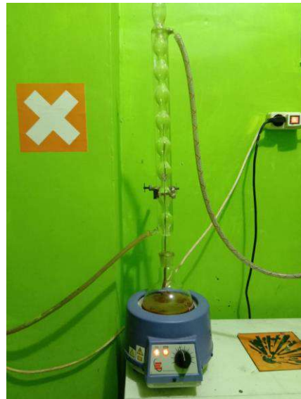
Kayu secang ditambah pelarut etanol baru diekstraksi secara reflux
