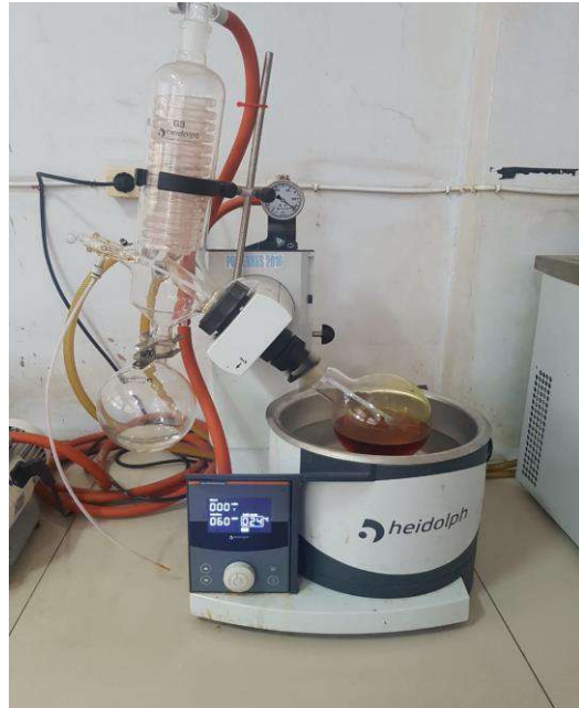
Rotary evaporator utk pekatkan ekstrak cair, pisahkan pelarut
