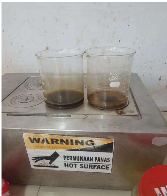
Water bath menguapkan sisa pelarut dr ekstrak pekat
