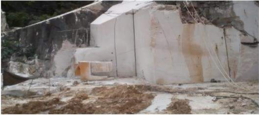
Pengergajian dengan elektrik diamond wire sling (edws) arah vertikal.
