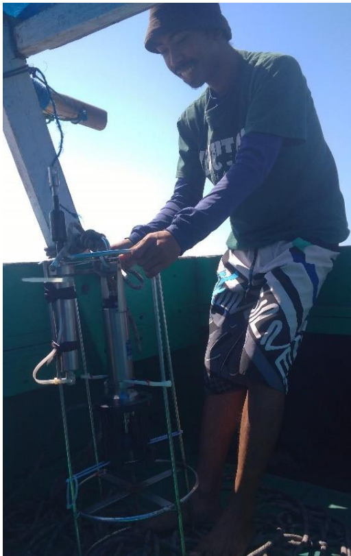
Penggunaan Electromagnetic Current Meter dan penggunaan Compact-TD
