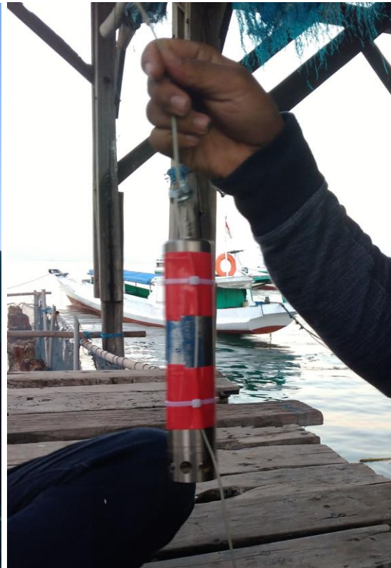
Penggunaan Electromagnetic Current Meter dan penggunaan Compact-TD
