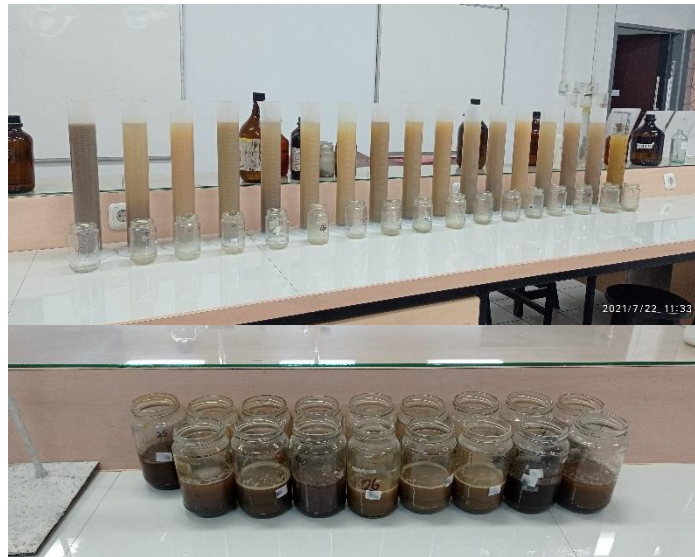
Proses pengukuran tekstur tanah menggunakan metode hidrometer
