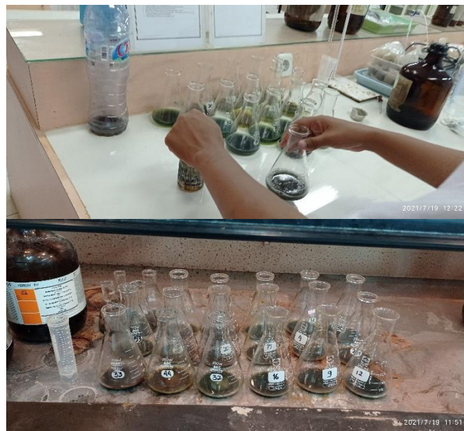
Proses pengukuran C-organik menggunakan metode Walkley and Black
