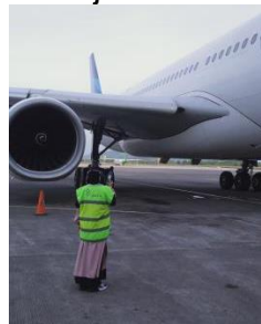
Gambar 3. Pengukuran Tingkat Bising Pesawat Boeing
