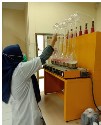
Pemasangan kealat destilasi
