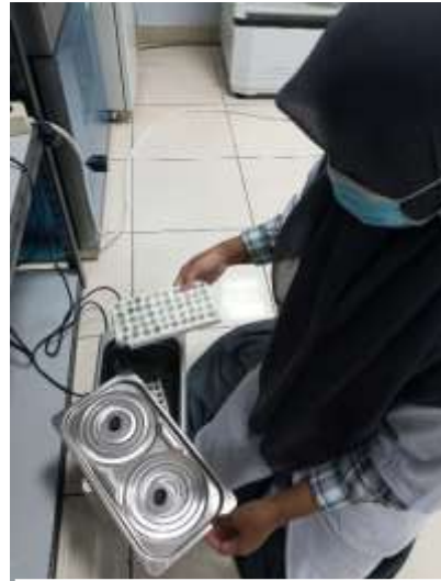
Menginkubasi sampel ke dalam waterbath pada suhu 75°C selama 2 jam (divortex setiap 30 menit)
