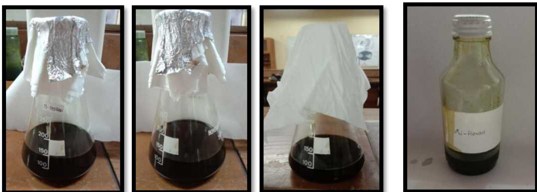
Gambar 3. Proses penguapan hingga mendapat ekstrak kental
