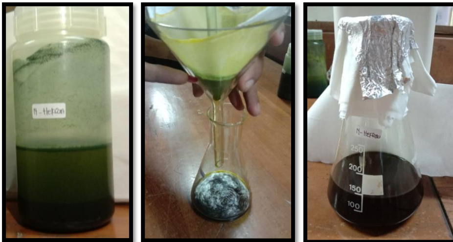
Gambar 2. Proses ekstraksi dengan metode maserasi
