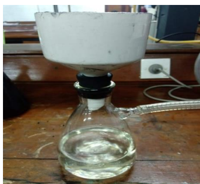
Gambar 7. Proses Penyaringan KAM
