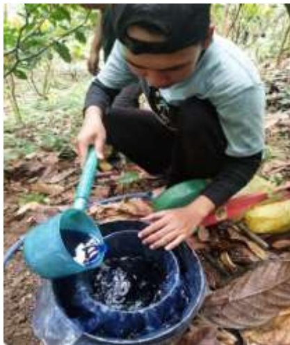
Pengisian air pada double ring infiltrometer
