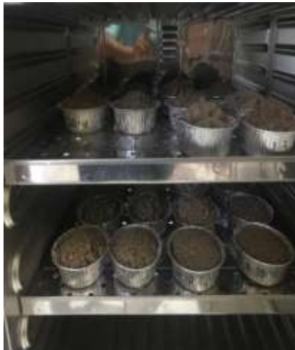
Pengovenen sampel tanah untuk mengukur kadar air menggunakan metode gravimetrik
