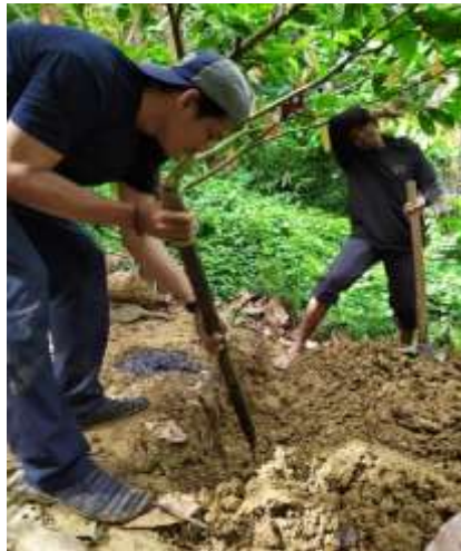
Penggalian penampang tanah untuk pengambilan sampel tanah
