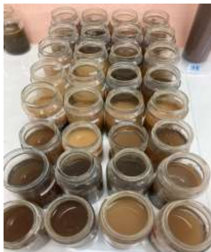
Proses pengukuran tekstur menggunakan metode hidrometer
