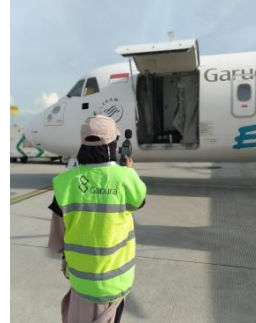
Gambar 2. Pengukuran Tingkat Bising Pesawat ATR
