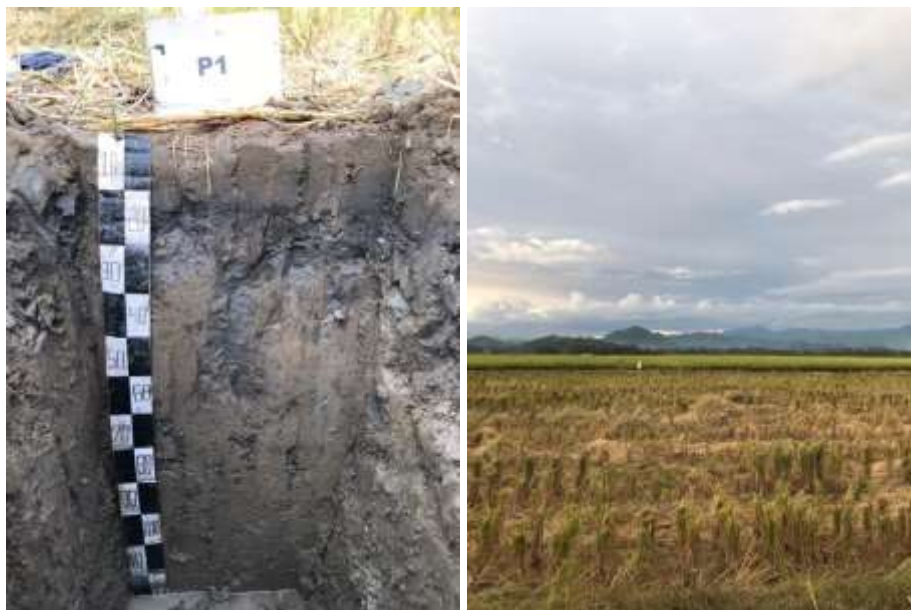
Gambar 5-1 Penampang profil tanah dan bentang lahan P1
