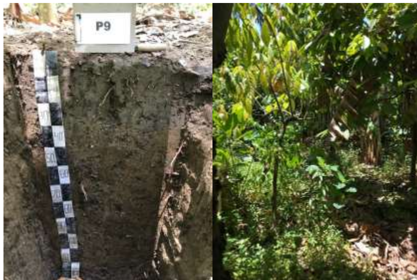
Gambar 5-9 Penampang profil tanah dan bentang lahan P9
