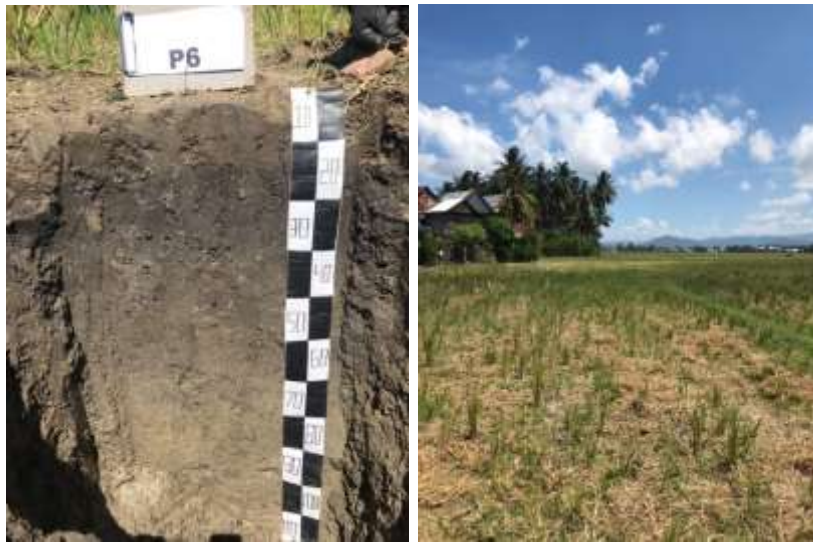
Gambar 5-6 Penampang profil tanah dan bentang lahan P6
