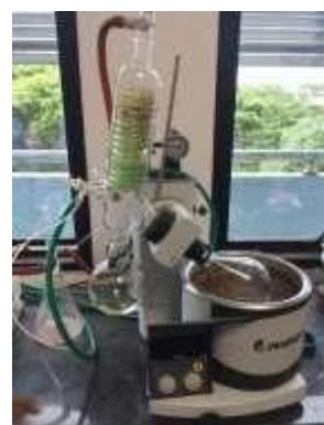
**Gambar 14. Pengeringan menggunakan Rotary Evaporator**
