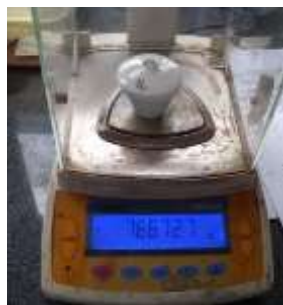
Gambar 16. Penimbangan simplisia dengan botol timbang untuk susut pengeringan
