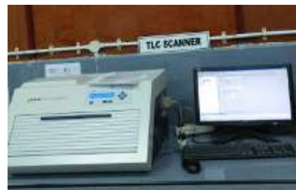
Gambar 23. Analisis lempeng KLT dengan alat TLC scanner
