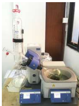
Gambar 20. Penguapan ekstrak cair menggunakan rotary evaporator
