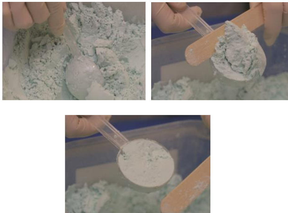
Gambar 2.1.4.3: Pengambilan bubuk alginat dengan scoop ukur Sumber: Scahell & Sheridan. Basic guide to dental materials; 2010
