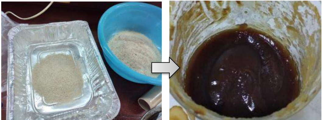
Sampel diayak dengan pengayak 100 mesh hingga didapatkan serat batang jagung
