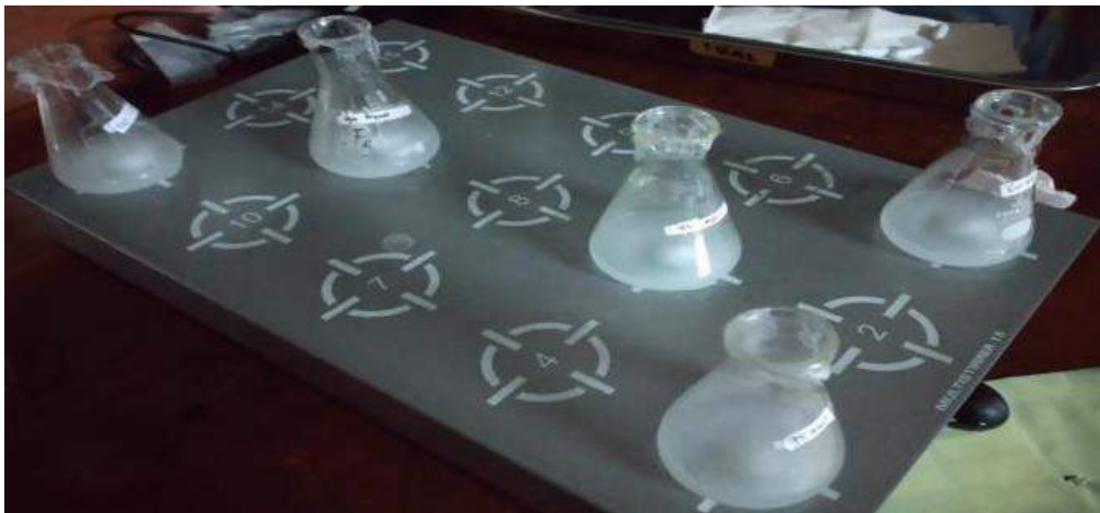
Proses adsorpsi antara logam \text{Cu(II)} dengan adsorben aerogel selulosa
