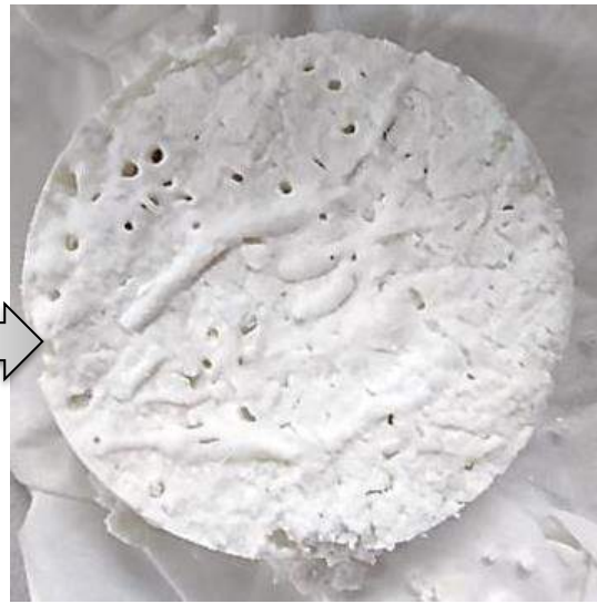
Hasil produk aerogel selulosa setelah freeze dryer
