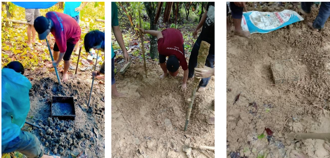
Gambar Lampiran 6. Proses penggalian ring sampel tanah dengan cara pengambilan sampel tanah monolit
