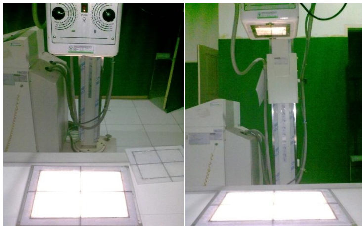
Gambar L2.2. Pengujian Akurasi Kolimasi ukuran kaset 30 x 40 cm pada FFD 60 cm
