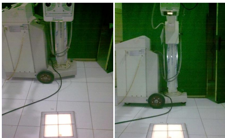
Gambar L4.3. Pengujian Akurasi Kolimasi ukuran kaset 35 x 35 cm pada FFD 120 cm
