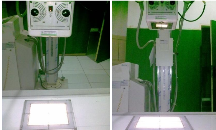
Gambar L2.1. Pengujian Akurasi Kolimasi ukuran kaset 24 x 30 cm pada FFD 60 cm
