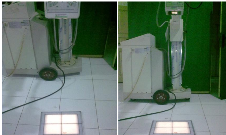
Gambar L4.2. Pengujian Akurasi Kolimasi ukuran kaset 30x 40 cm pada FFD 120 cm
