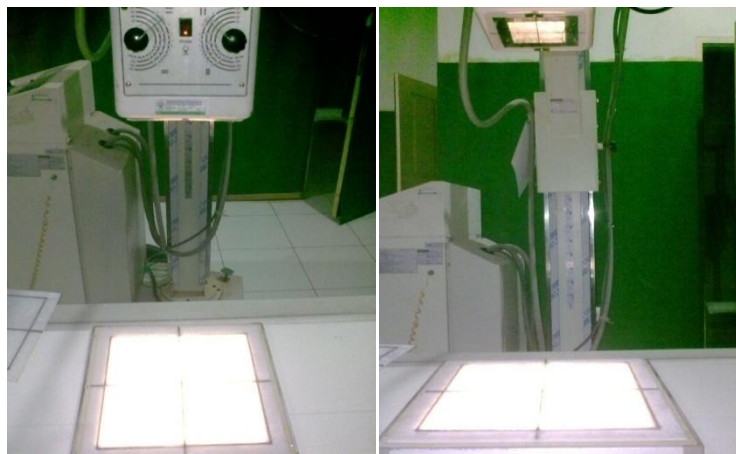
Gambar L2.3. Pengujian Akurasi Kolimasi ukuran kaset 35 x 35 cm pada FFD 60 cm
