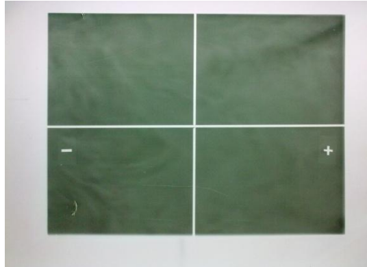
Gambar L5.4. Gambaran Radiograf hasil pengujian Collimator Test Tool pada Film Ukuran 24 cm x 30 cm dengan FFD 90 cm setelah dikoreksi
