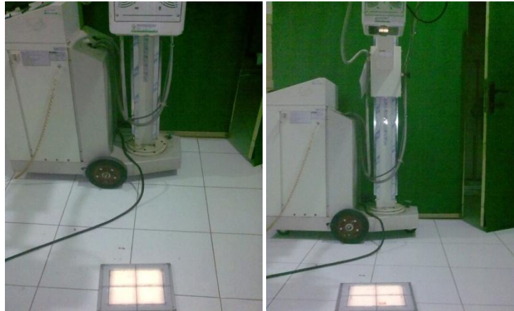
Gambar L4.1. Pengujian Akurasi Kolimasi ukuran kaset 24 x 30 cm pada FFD 120 cm
