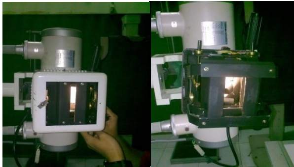
Gambar 2.5. Kolimator Pesawat Sinar-X (dokumentasi)
