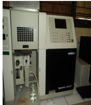
Spektrofotometer serapan Atom (SSA) alat untuk mengukur kadar logam berat
