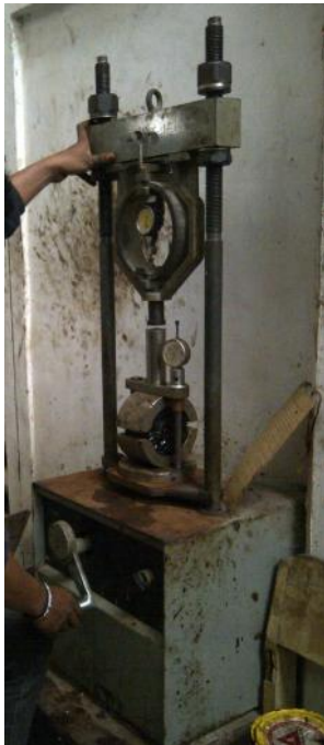
Gambar 31. Pengujian Marshall Test
