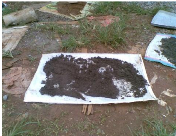
Gambar 4. Penjemuran Agregat Halus sampai Kering Permukaan (SSD)
