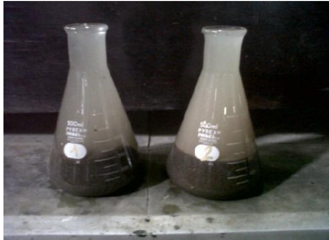
Gambar 7. Sampel yang Telah Kering Permukaan di Masukkan Ke dalam Piknometer Ditambahkan Air
