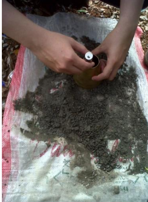
Gambar 5. Pengujian Agregat Halus Kering Permukaan Menggunakan Kerucut Terpancung
