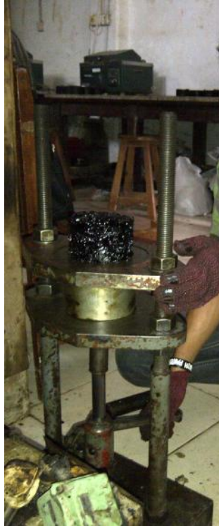
Gambar 26. Pengeluaran Sampel dari Mould Menggunakan Ejector
