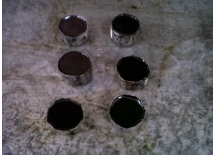
Gambar 12. Penyiapan Sampel Pengujian Penetrasi Aspal dan Penurunan Berat Aspal
