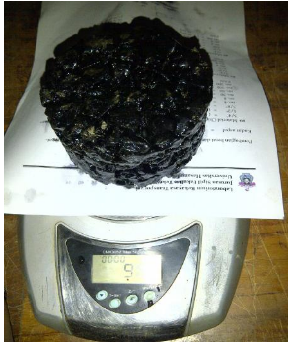
Gambar 28. Penimbangan Sampel untuk Pengujian Marshall
