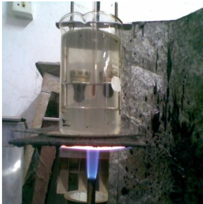
Gambar 17. Pengujian Titik Lembek Aspal
