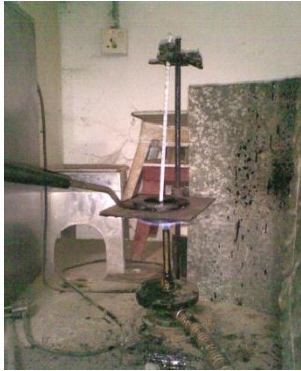
Gambar 18. Pengujian Titik Nyala dan Titik Bakar Aspal
