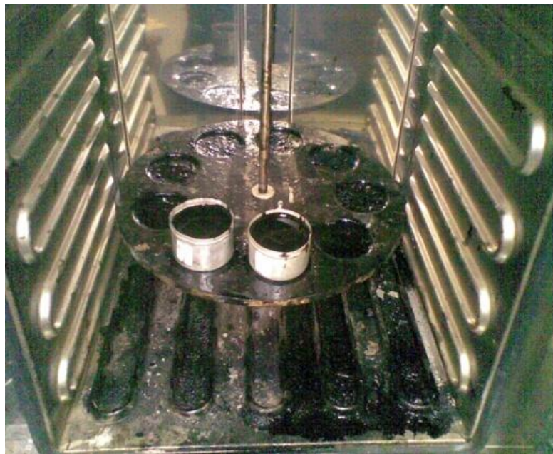
Gambar 15. Pengujian Penurunan Berat Aspal pada Oven Berpinggan
