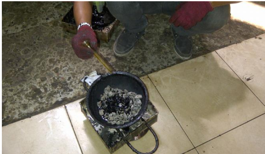
Gambar 24. Pencampuran Wetfix dengan Agregat
