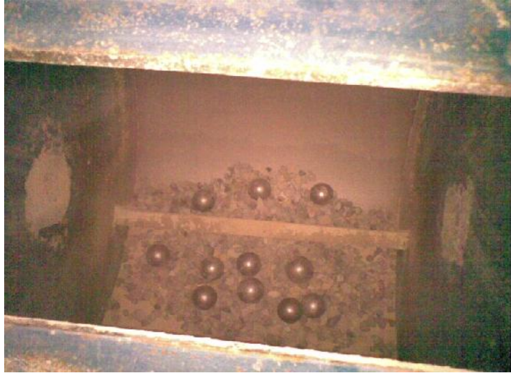
Gambar 10. Pengujian Keausan dengan Mesin Los Angeles
