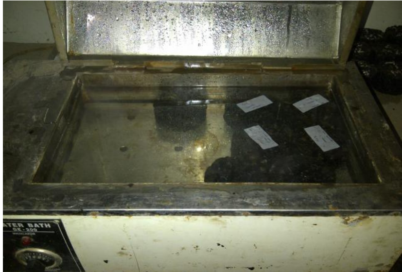
Gambar 30. Perendaman Sampel ke dalam Waterbath pada Suhu 60 0 Sebelum Pengujian Marshall
