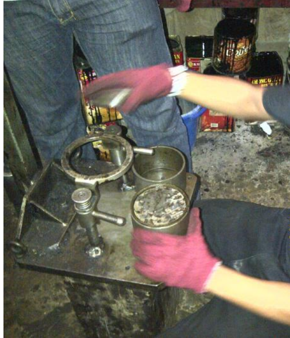
Gambar 25. Pengeluaran Mould dari Alat Penumbuk
