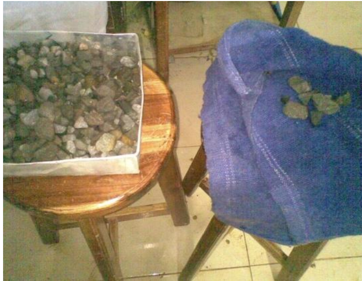
Gambar 3. Pengeringan Agregat Kasar sampai Kering Permukaan
