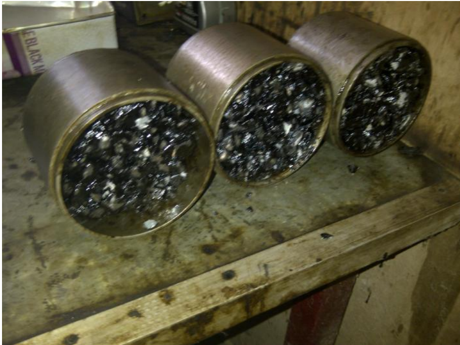
Gambar 25. Pengeluaran Mould dari Alat Penumbuk
