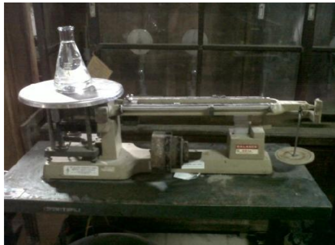
Gambar 6. Penimbangan Piknometer untuk Pengujian B_j Agregat Halus
