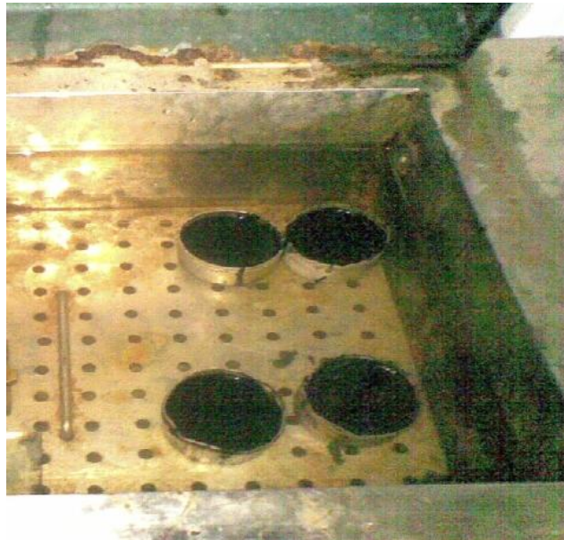
Gambar 13. Perendaman Sampel Sebelum Pengujian Penetrasi
