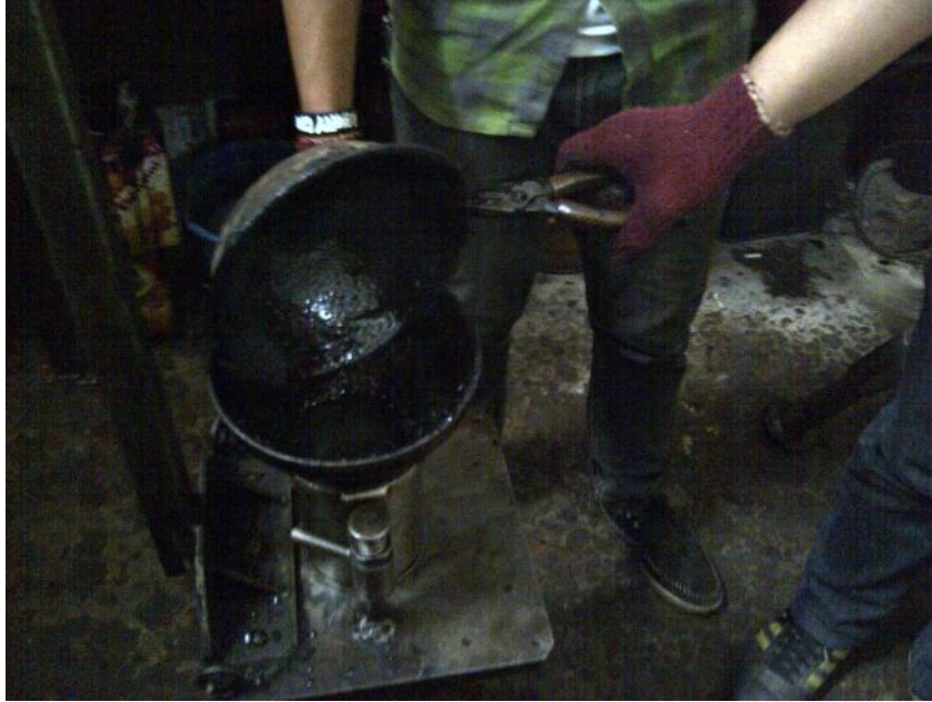
Gambar 24. Pemasukkan Sampel/Briket ke dalam Mould
