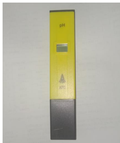
Gambar 2.2 pH Meter Sumber: Data Primer, 2021
