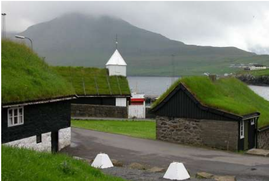
Gambar 3. Atap Hijau Tradisional pada pemukiman di Kepulauan Faroe Denmark ( www.greenroof.or )
