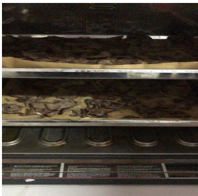
Mengeringkan umbi porang dengan oven pada suhu 150°C
